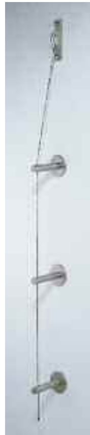
Edelstahlseil 4 mm, 820-0400 einseitig Gabel verpresst 881-0400 anderseitig Seilende glatt mit Seilendkappe 904-0400 Stainless steel wire rope 4 mm, 820-0400 one side fork swaged 881-0400 other side wire rope end cap 904-0400
